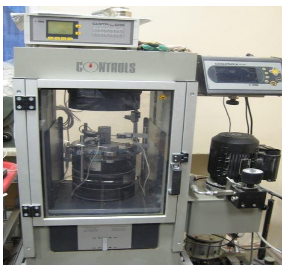
Сурет 1.6 - Керн үлгілері және оларды зертханада Pilot 4 прессінде сынау
